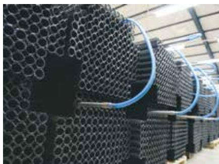
Serienproduktion der DELPHIN® compact Festbettkörper
