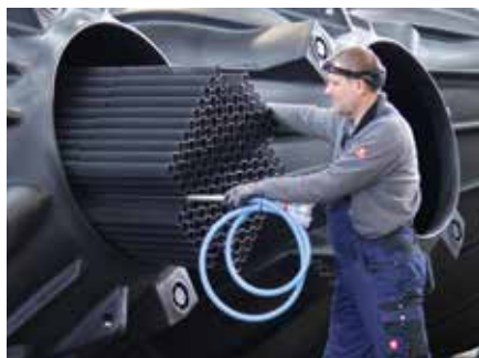
Montage der Festbettkörper in DELPHIN® compact Behälter
