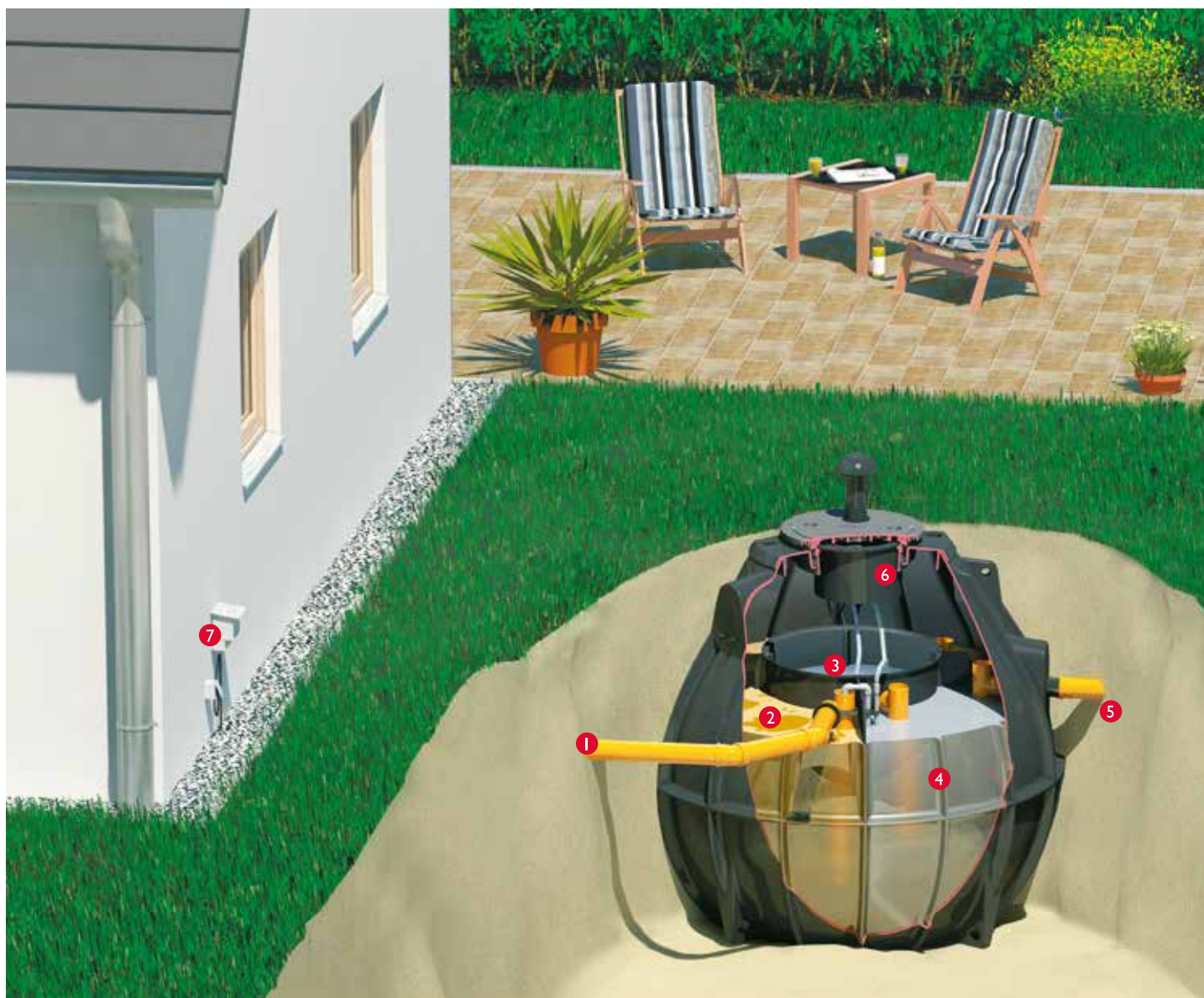
1 Zulauf, 2 Vorklärung, 3 Festbettreaktor, 4 Nachklärstufe, 5 Ablauf, 6 Verdichter, 7 Steuerung
