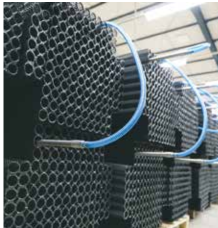
Producción serial de insertos de lecho fijo para las plantas DELPHIN® compact
