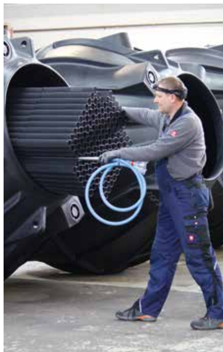
Montaje los insertos de lecho fijo en una planta DELPHIN® compact
